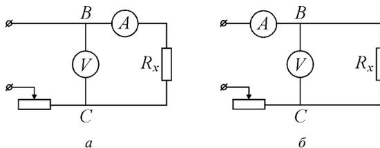
Рис. 3.2.3. Измерение сопротивления
