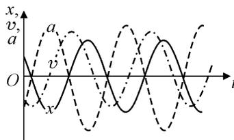
Рис. 1.5.2. Смещение, скорость и ускорение при колебаниях
