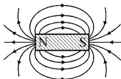
Рис. 3.3.2. Магнитное поле постоянного магнита
