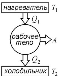
Рис. 2.2.4. Схема теплового двигателя
