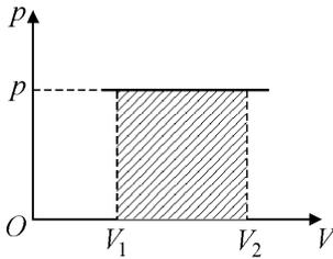
Рис. 2.2.1. Работа газа при изобарном процессе
