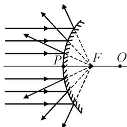
Рис. 3.6.4. Падение узкого пучка лучей на выпуклое зеркало
