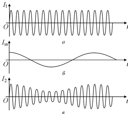
Рис. 3.5.10. Амплитудная модуляция
