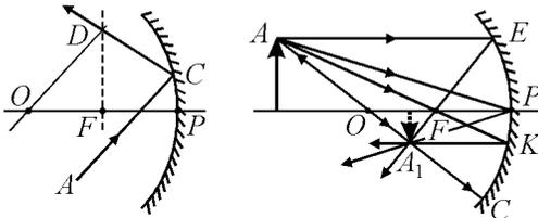
Рис. 3.6.5. Построение действительного изображения в вогнутом зеркале
