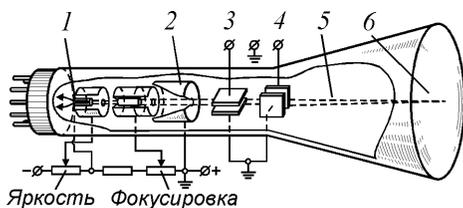
Рис. 3.2.6. Электронно-лучевая трубка
