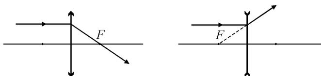
Рис. 3.6.13. Преломление луча, параллельного главной оптической оси
