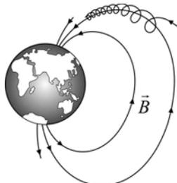
Рис. 3.3.7. Движение частиц в магнитном поле Земли
