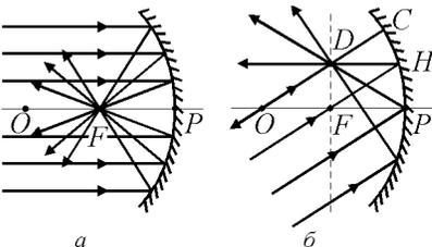
Рис. 3.6.3. Падение узкого пучка лучей на вогнутое зеркало
