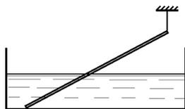
Решение. Силы, действующие на спицу, изображены на рисунке, где  $m\vec{g}$  – сила тяжести;  $\vec{T}$  – сила натяжения нити;  $\vec{F}_A$  – архимедова сила,  $\vec{F}'$  – сила реакции дна сосуда. Сила тяжести приложена к центру спицы, архимедова сила – к центру погруженной в воду ее части. Масса спицы  $m$  и модуль архимедовой силы выражаются следующим образом:  $m = SL\rho_{\text{а}}$ ,  $F_A = Sl\rho_{\text{в}}g$ .
