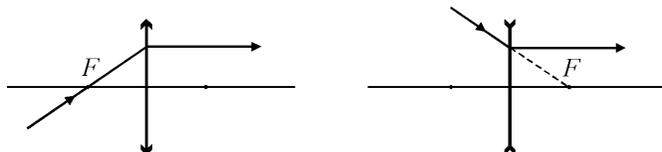
Рис. 3.6.14. Преломление луча, проходящего через фокус линзы
