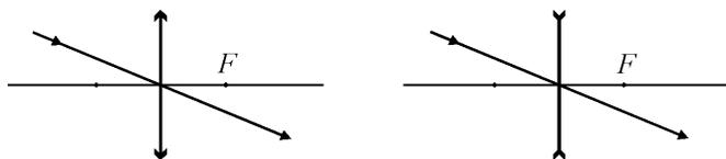
Рис. 3.6.15. Прохождение луча через оптический центр линзы
